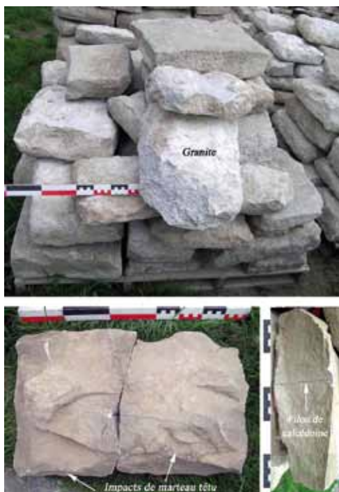
8 - Pavés de la cour d'honneur dégagés lors des fouilles de 2010 (Pôle archéologique départemental du CG des P.-O.). En haut pavé en granite et en bas, en grès siliceux des Moleres , au Boulou, sur un exemplaire traversé par une veinule de calcédoine. Ces pavés ont été équarris et amincis au marteau têt.
